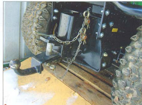
Další jedinečná úprava – stačí vyndat pojistku dole, vytáhnout kolík a koule se může vysunout z tažného závěsu
