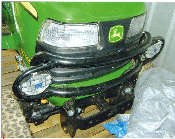
Takový sklopný čelní rám se světlomety by určitě uvítalo více majitelů tohoto traktoru. Málokdo by poznal, že jde o vlastní návrh Vojtěcha Kubíka
