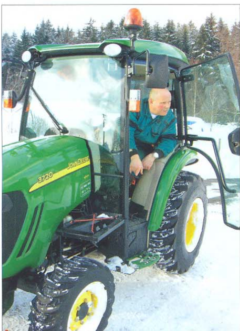
Rám za předním kolem vlevo před kabinou slouží k převážení motorové pily
